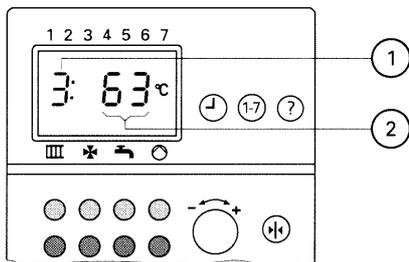
Sie können an der Schaltuhr der Viessmann Trimatik durch die angeschlossenen Sensoren die Isttemperaturen abfragen. Die Zuordnung der Kennziffern ①, die Bedeutung der Anzeigen und die angezeigten Isttemperaturwerte ② können Sie der nachfolgenden Tabelle entnehmen.
